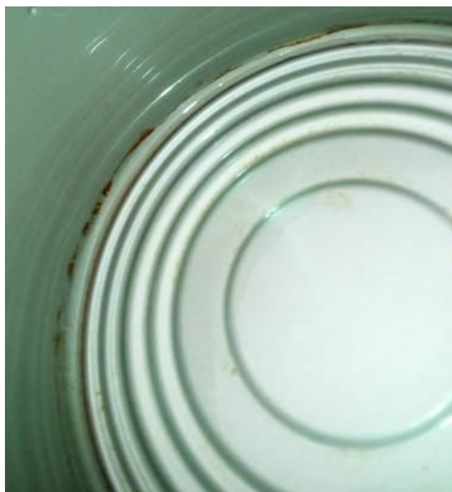
Рис. 1. Коррозия металлической банки мясных консервов марки «Пан Іван».
