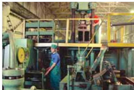
Стенд для випробувань великого вагонного литва
