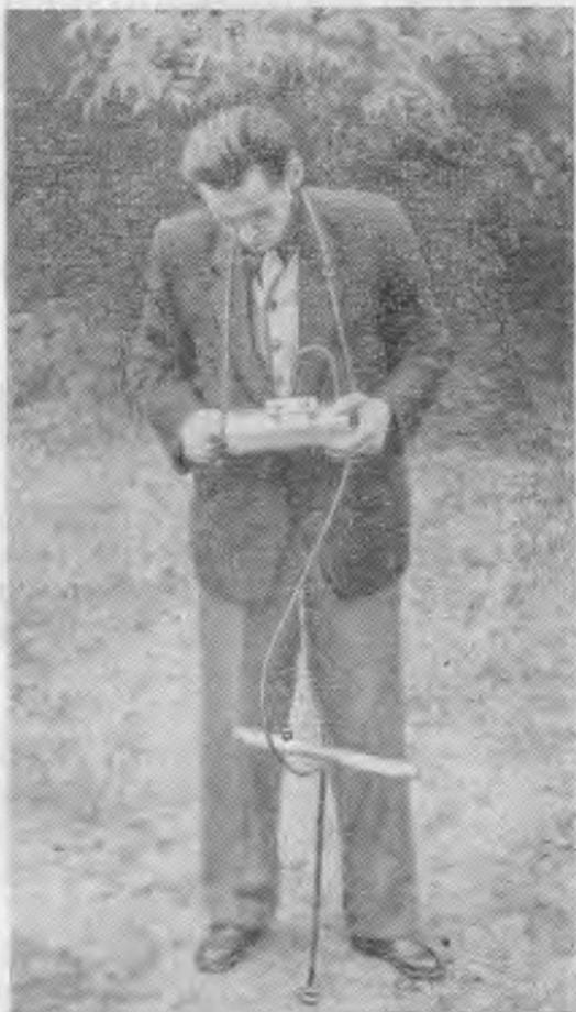
Рис. 2. Поисковый прибор для отыскания трупа в земле (в работе)
