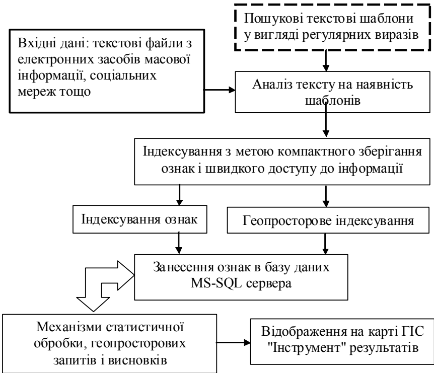
Рис. 2. Система що пропонується для моніторингу текстової інформації та аналізу соціального стану та розвитку кризових явищ
