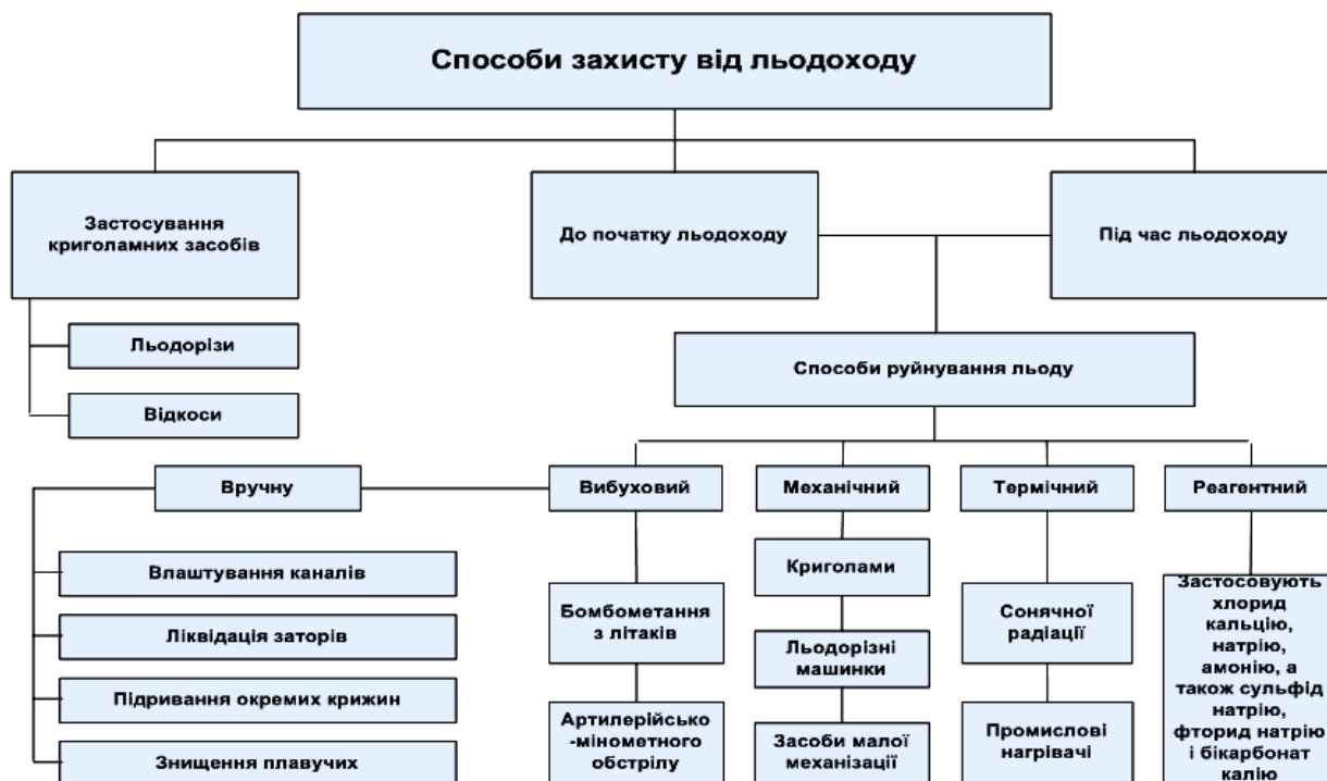
Рис. 1. Способи захисту мостів від льодоходу.
