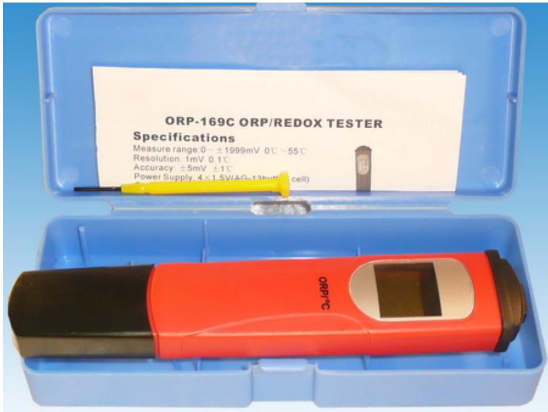
Рис. 4. Портативний вимірювач редокс-потенціалу ORP-169C.
