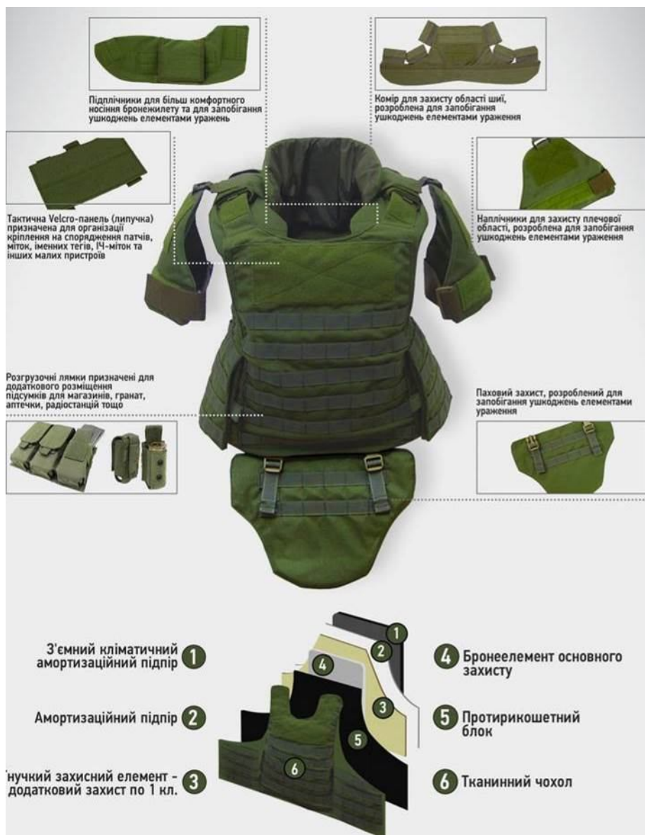
Рис. 1. Загальний вигляд та структура «гелевого» бронежилету.
