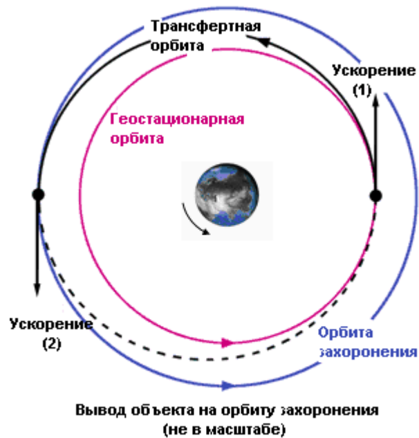
Рис. 2. Схема виведення космічного апарату на орбіту захоронення [7].
