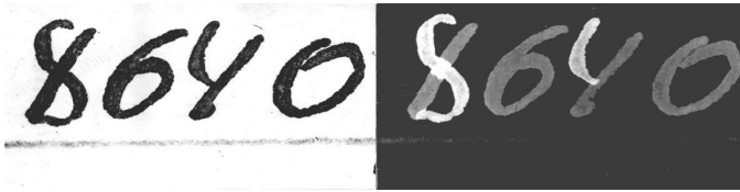
Рис. 18. Виявлення виправлення за допомогою ультрафіолетового освітлювача
