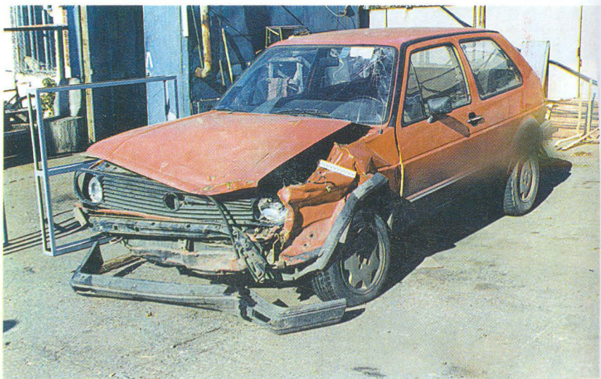
ФОТО 6. Вузловий знімок. Фіксує характер, розташування і величину деформацій у передній частині автомобіля Volkswagen-Golf. Використовується масштабна лінійка довжиною 20 см. Дає уявлення про розміри зони деформації
