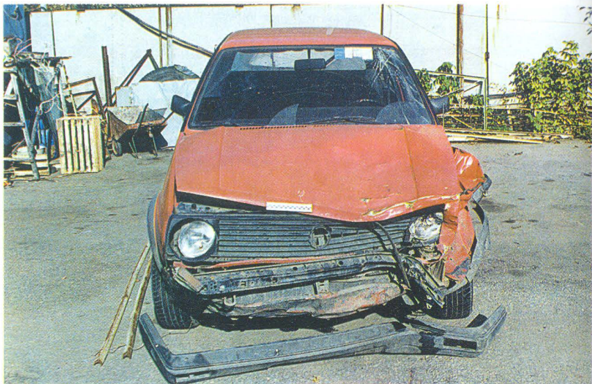
ФОТО 5. Вузловий знімок. Відображає характер, розташування і розміри зони пошкоджень у передній частині автомобіля Volkswagen-Golf. Використовується масштабна лінійка довжиною 20 см. Знімок дає змогу дійти висновку про локалізацію і розміри пошкоджень
