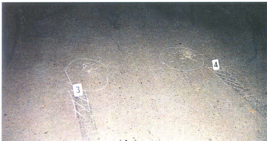
ФОТО 4. Переривання слідів гальмування знаходиться у безпосередній близькості від двох симетрично розташованих осців ґрунту з-під передніх крил автомобіля ВАЗ-21099. Зазначена слідова інформація дозволяє визначити розташування автомобіля щодо елементів проїзної частини і кінцевого розташування ВАЗ-21099 у момент наїзду, а з урахуванням розташування пошкоджень на ТЗ — встановити точне розташування місця наїзду на проїзній частині дороги
