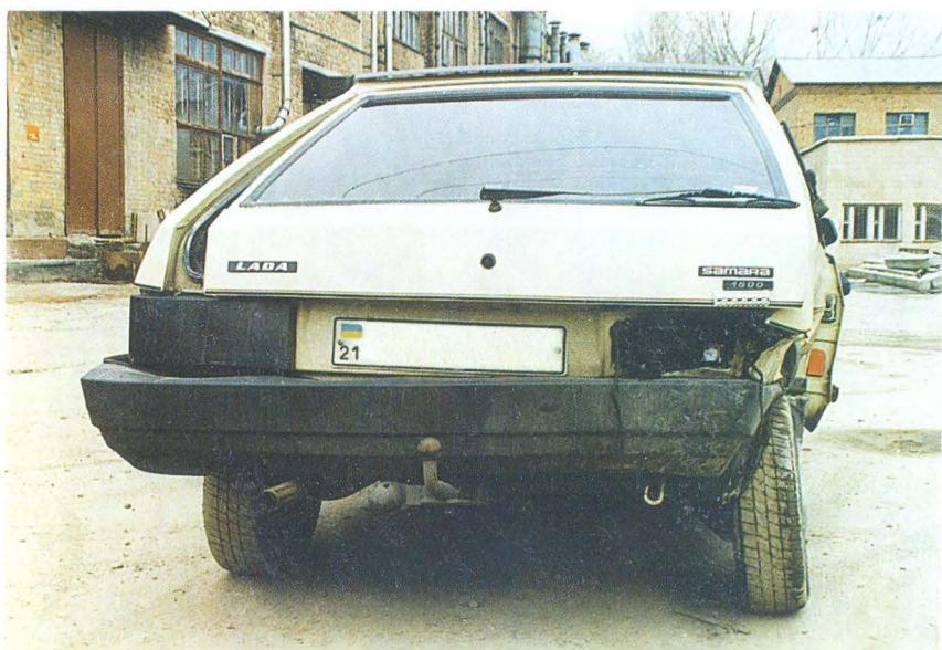
ФОТО 4. Характер пошкоджень і слідоутворень у правій задньобоківій частині кузова автомобіля ВАЗ-2108
