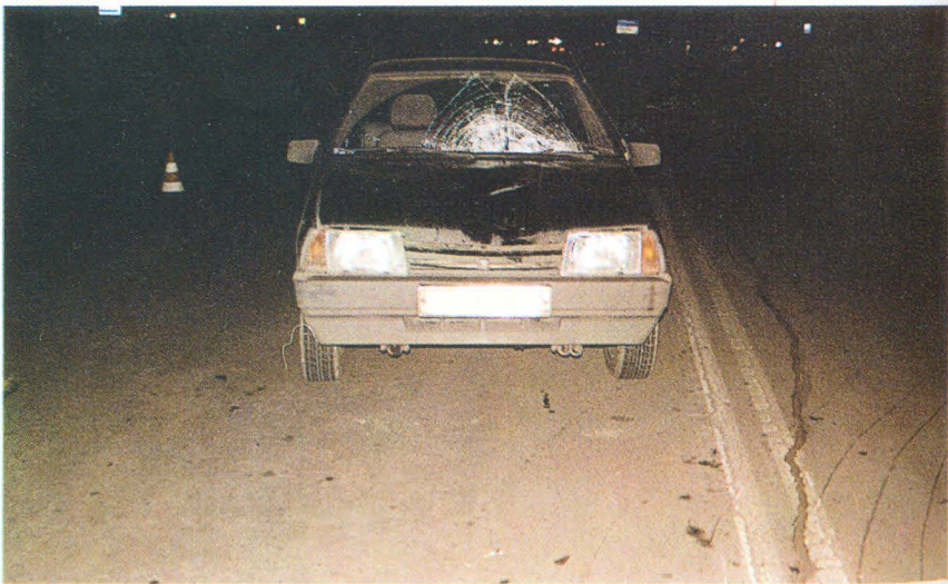
ФОТО 2. Кінцеве розташування автомобіля ВАЗ-21099 щодо елементів проїзної частини (ліній дорожньої розмітки). На передній частині автомобіля добре видно сліди контактної взаємодії з тілом пішохода
