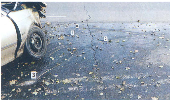
ФОТО 4. Вузловий знімок. При виборі іншого ракурсу (у поперечному до краю проїзної частини напрямку) фотографування явно проглядаються сліди коліс автомобіля Opel-Astra, що залишилися на кінцевій фазі зіткнення – відкиданні
