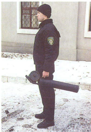
ФОТО 1. Малогабаритний, компактний, зручний у транспортуванні й експлуатації електронний вимірювач відстаней MD-21E (у зібраному для транспортування вигляді)
