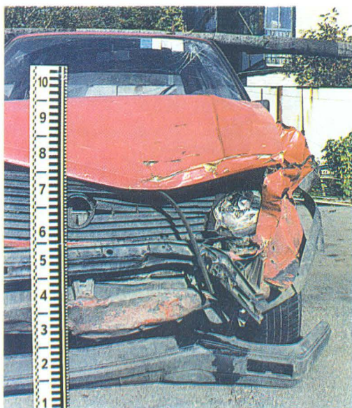
ФОТО 8. Детальний знімок. Дозволяє точно визначати розміри і розташування пошкоджень у висоту в передній частині автомобіля Volkswagen-Golf. Використовувалася масштабна лінійка довжиною 100 см
