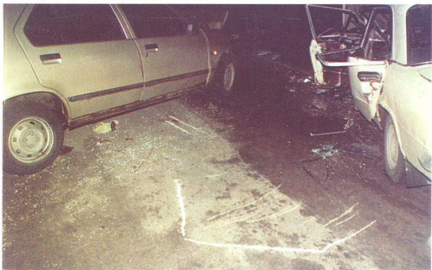
ФОТО 4. Вузловий знімок. Відображає розташування слідів щодо кінцевого положення автомобілів. Добре видно помічені крейдою: фрагмент сліду колеса ВАЗ-2101, а також зону зчісувань і борозен на дорожньому покритті, що залишили днище та елементи підвіски того ж автомобіля.
