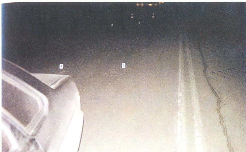
ФОТО 3. Розташування слідів гальмування автомобіля ВАЗ-21099, які відобразилися, щодо елементів проїзної частини (ліній дорожньої розмітки) і кінцевого положення автомобіля ВАЗ-21099
