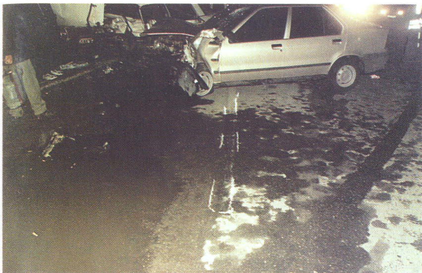
ФОТО 3. Вузловий знімок. Фіксує характерну слідову інформацію, зокрема слід відкидання ТЗ, залишений колесом автомобіля ВАЗ-2101
