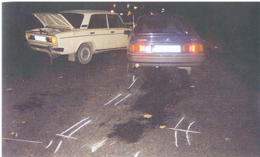
ФОТО 1. На місці ДТП зафіксовано сліди бокового зрушення коліс передньої осі автомобіля Ford-Sierra, зчісування на дорожньому покритті від елементів його передньої підвіски, сліди витікання охолоджувальної рідини з пошкодженого радіатора
