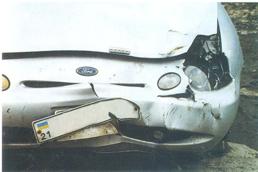
ФОТО 3. Характер пошкоджень і слідоутворень у передній лівій частині кузова автомобіля Ford-Scorpio
