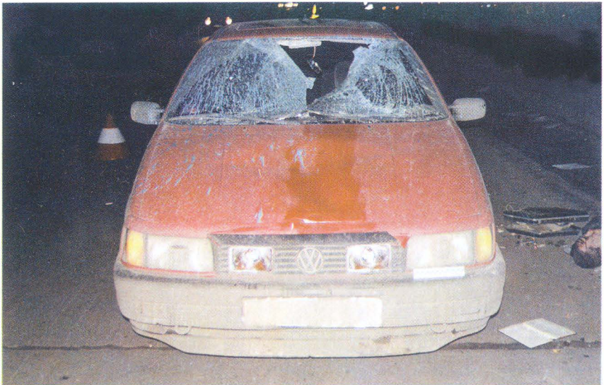
ФОТО 6. Вузловий знімок. Дає змогу дійти висновку про характер і розташування пошкоджень у передній частині автомобіля Volkswagen-Passat
