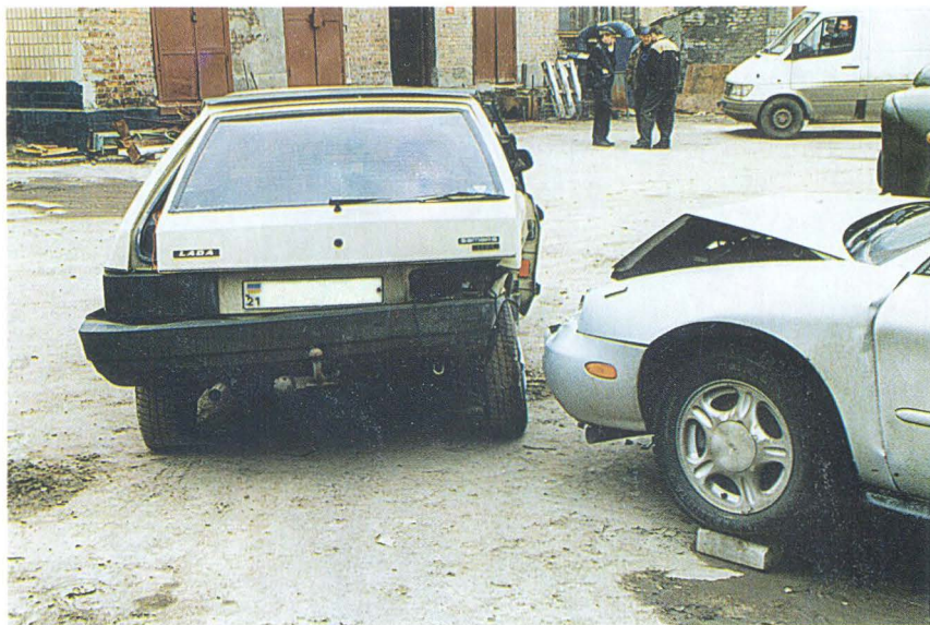
ФОТО 5. Зіставлення транспортних засобів (натурна реконструкція). Проводиться з урахуванням розташування, величини, спрямованості, характеру пошкоджень і деформацій
