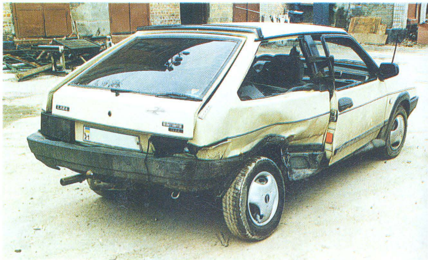
ФОТО 2. Надано на дослідження автомобіль ВАЗ-2108. Основні сліди і пошкодження розташовані у правій задньобоківій частині кузова автомобіля
