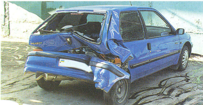
ФОТО 2. Вузловий знімок. Фіксує характер, розташування і величину деформацій у задній частині автомобіля Peugeot-106. Використовується масштабна лінійка довжиною 20 см. За цим знімком можна визначити натуральну величину зони деформації
