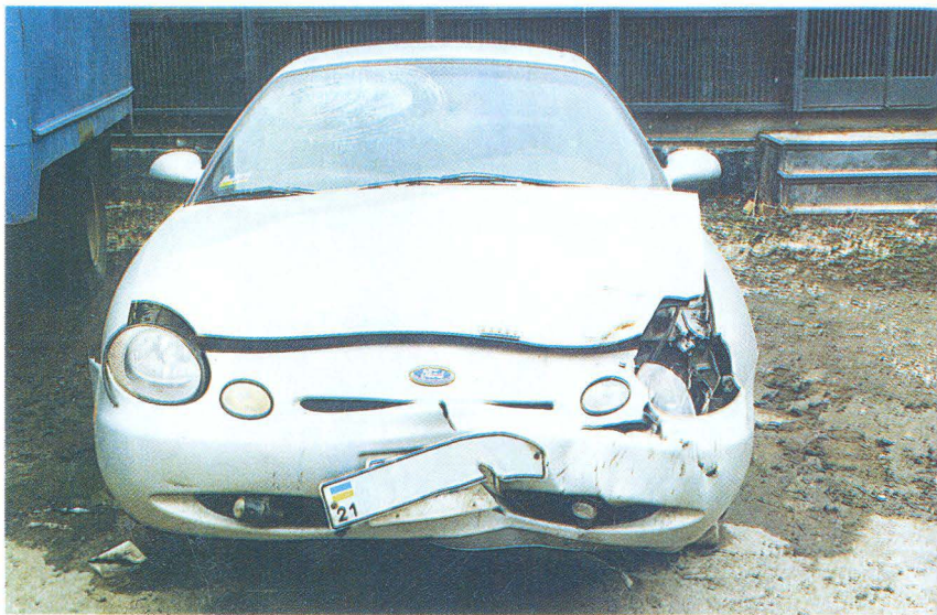
ФОТО 1. Надано на дослідження автомобіль Ford-Scorpio. Основні сліди і пошкодження розташовані у передній лівій частині кузова автомобіля
