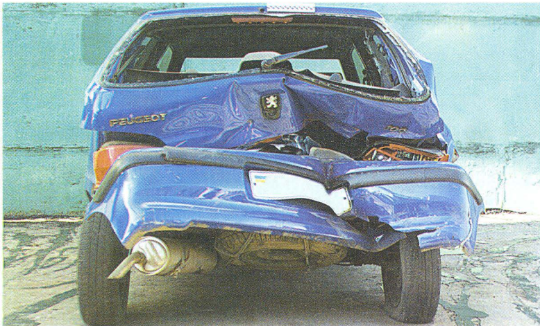
ФОТО 1. Вузловий знімок. Відображає характер, розташування і розміри зони пошкоджень у задній частині автомобіля Peugeot-106. Використовується масштабна лінійка довжиною 20 см. Знімок дає змогу дійти висновку про локалізацію і розміри пошкоджень
