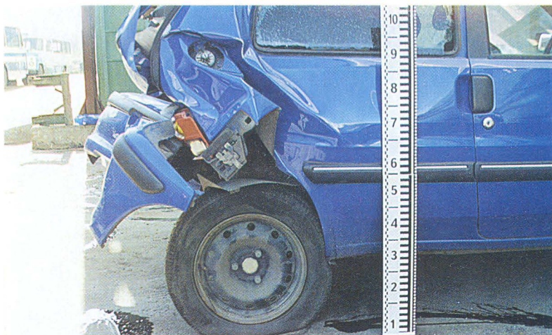
ФОТО 3. Детальний знімок. Дає змогу дійти висновку про характер і розміри пошкоджень у задній частині автомобіля Peugeot-106. Використано розроблену експертами НДЕКЦ масштабну лінійку довжиною 100 см, що дозволяє підвищити точність вимірів і врахувати характер пошкоджень (наприклад, ту обставину, що колесо спущене)
