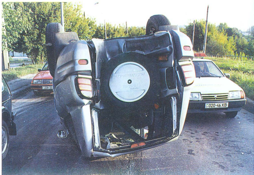
ФОТО 7. Вузловий знімок. Характер деформацій і пошкоджень у задній частині автомобіля RAV-4
