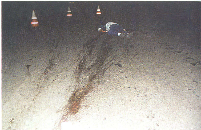
ФОТО 1. Знімок зроблено у напрямку, паралельному краю проїзної частини. Характер слідоутворень на дорожньому покритті дає змогу дійти висновку про розташування місця наїзду на пішохода з подальшим волочінням тіла
