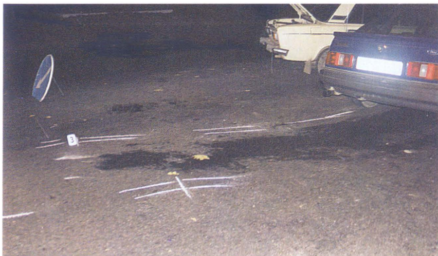
ФОТО 2. У розслідуваній дорожній ситуації зафіксовані на місці пригоди сліди дозволяють визначити розташування автомобіля Ford-Sierra у момент зіткнення, а отже — встановити досить точне розташування місця зіткнення ТЗ
